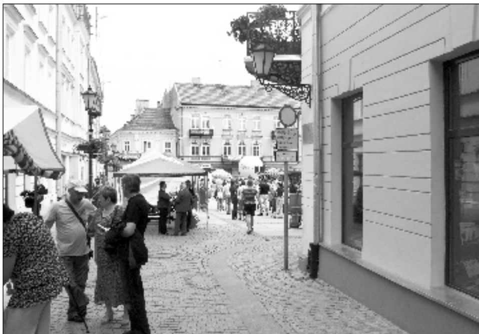
Piotrków Trybunalski, ulica Sieradzka – zlikwidowano na niej krawężniki, całą nawierzchnię uliczek Starówki jak i rynku wyłożono płytami i kostką z granitu. W tym stylu urządzą także ulicę Zamkową wiodącą z rynku do Zamku Królewskiego.
