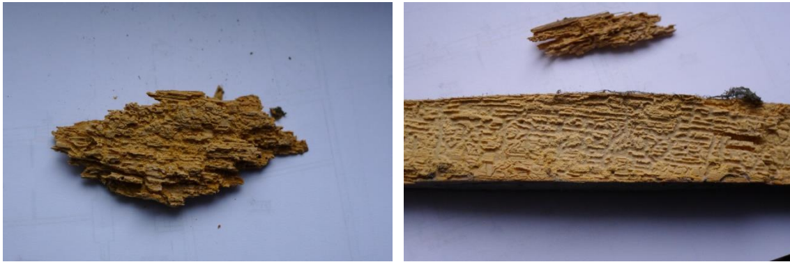
Rysunek 30. Strop nad parterem. Uszkodzone drewno belek
