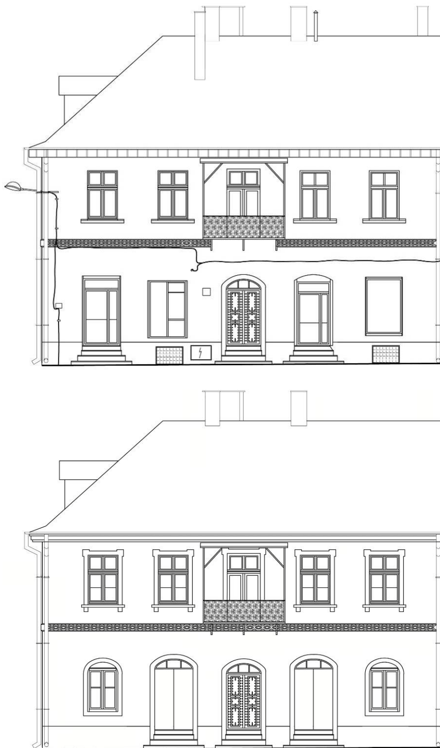
Ryc. 5.1. Elewacja frontowa (zachodnia) od strony placu 11 listopada: u góry stan istniejący, u dołu propozycja odtworzenia pierwotnego układu otworów oraz usunięcia dysharmonizujących elementów wtórnych (oprac. B.M. Walczak na podstawie inwentaryzacji wyk. przez M. Pabicha z zespołem).
