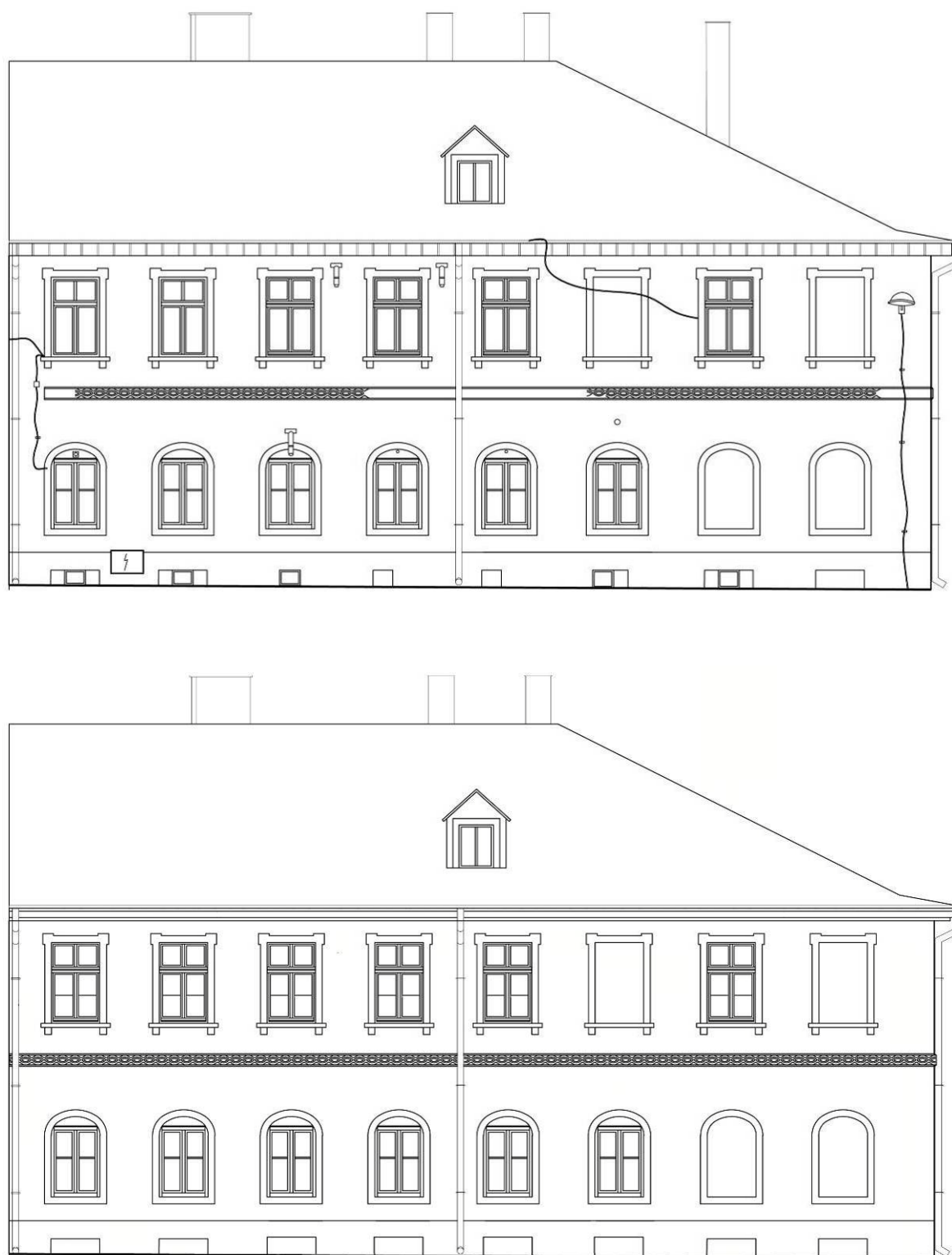
Ryc. 5.2. Elewacja boczna (północna) od strony ulicy Warszawskiej: u góry stan istniejący, u dołu propozycja odtworzenia pierwotnego układu otworów oraz usunięcia dysharmonizujących elementów wtórnych (oprac. B.M. Walczak na podstawie inwentaryzacji wyk. przez M. Pabicha z zespołem).
